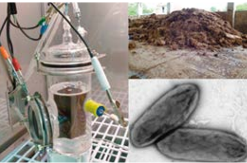
有機廃棄物処理を燃料に発電する微生物燃料電池
