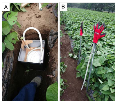
写真1 畝間に設置したキャピラリーライシメーター A: 土壌の構造を乱さないように畝間を55 cm掘る B: 土を埋め戻した状態。目印に赤い手袋を用いた。
