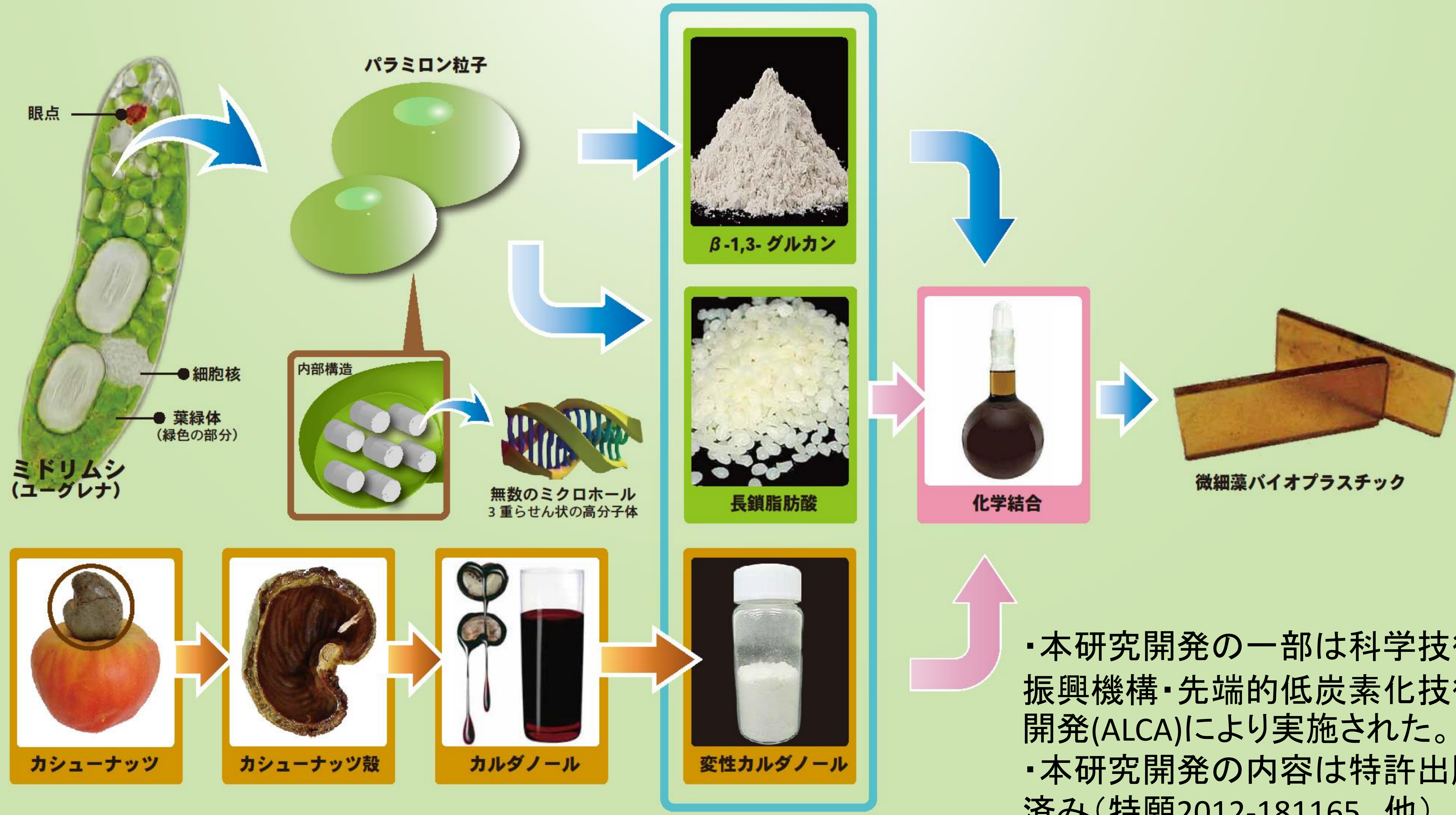
ミドリムシから微細藻バイオプラスチックへの製造工程
