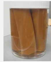
鉄酸化物含有凍結ゲル砒素吸着材
