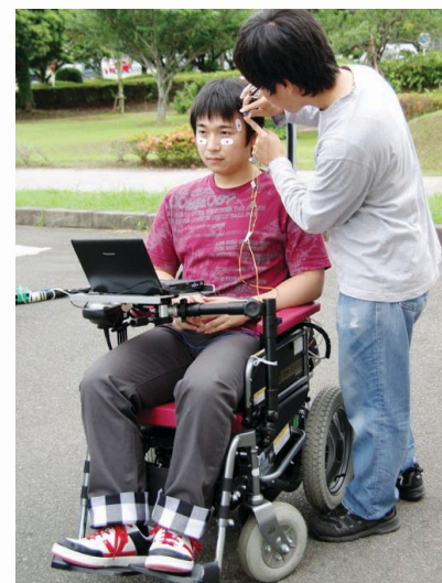
図1:顔の表情を用いたハンズフリー電動車椅子
