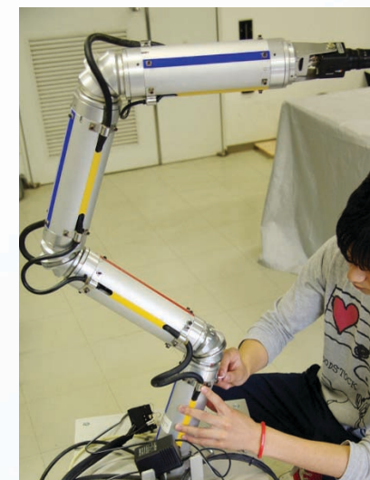
図2:視覚機能を有する多関節ロボット
