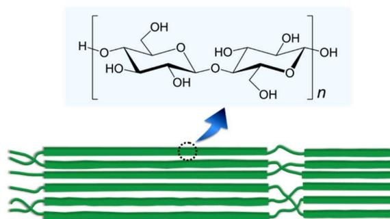
図1. セルロース化学構造(上)とセルロース繊維構造の模式図(下)
