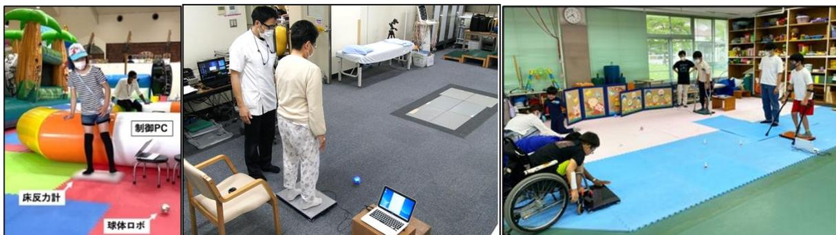
ロコボットの構成: ロボット、床反力計、PC。体の重心を前後左右に動かしロボットを操作する。
