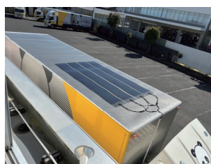
太陽光パネルを設置したトラック
