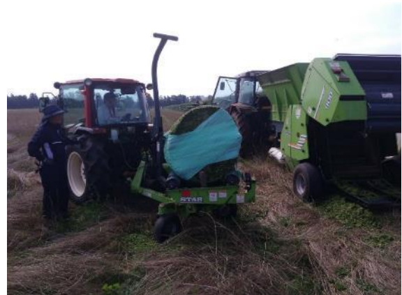
写真 9—1 （左）梱包圧通常設定、ネット張力通常、ネット 3 倍巻きでの梱包・排出 状況
