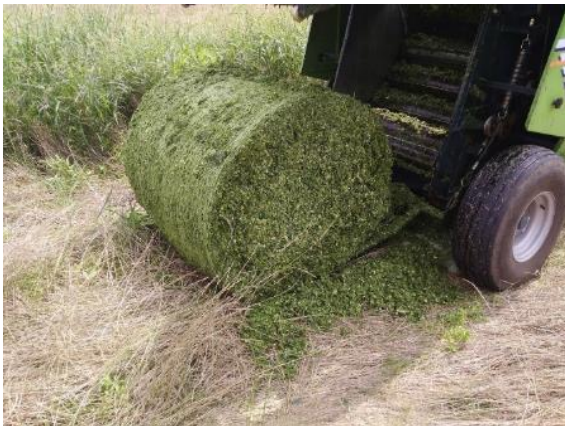
写真9—4 (左)梱包圧最大設定、ネットの張力を2.8倍に設定し、ネットの巻き数は3倍とした場合の梱包・排出状況。(右)ラップ後のロールベールの状況(手前から写真9—1、写真9—3、写真9—4のロールをラップしたものです)
