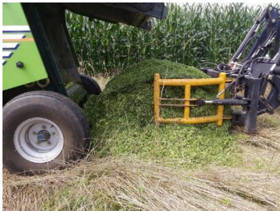
写真 9—2 梱包圧最大設定、ネット張 力 2.4 倍に設定し、ネットの巻き数は通 常とした場合の梱包・排出状況
