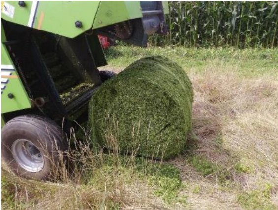
写真9—3 (左)梱包圧最大設定、ネットの張力を2.4倍に設定し、ネットの巻き数は3倍とした場合の梱包・排出状況、(右)グリッパの保持状況(慎重に行う必要がありました)
