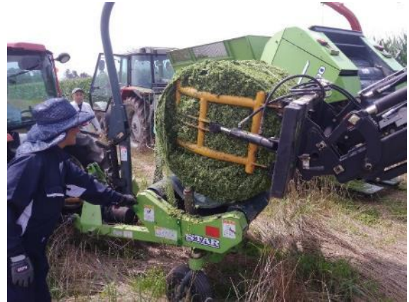
写真9—3 (左)梱包圧最大設定、ネットの張力を2.4倍に設定し、ネットの巻き数は3倍とした場合の梱包・排出状況、(右)グリッパの保持状況(慎重に行う必要がありました)
