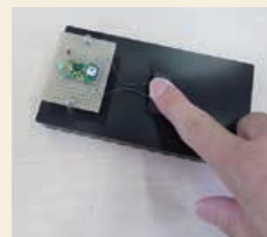
体温でLEDを光らせる熱電変換技術
