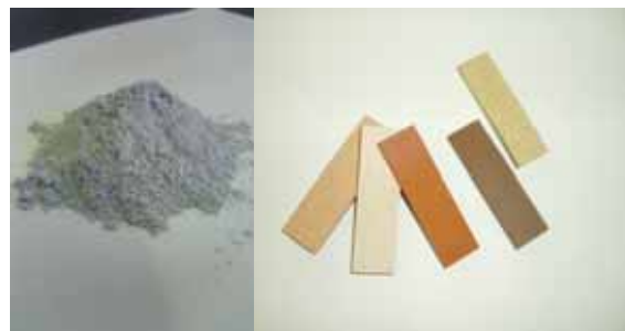
図 6-1 再生紙スラッジおよび作製したエコタイル
