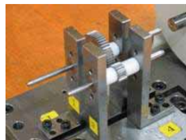
図 6-6 小型歯車減速機用試験歯車対
