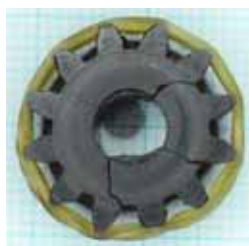
図 6-5 ミニ歯車ポンプ用歯車の損傷例
