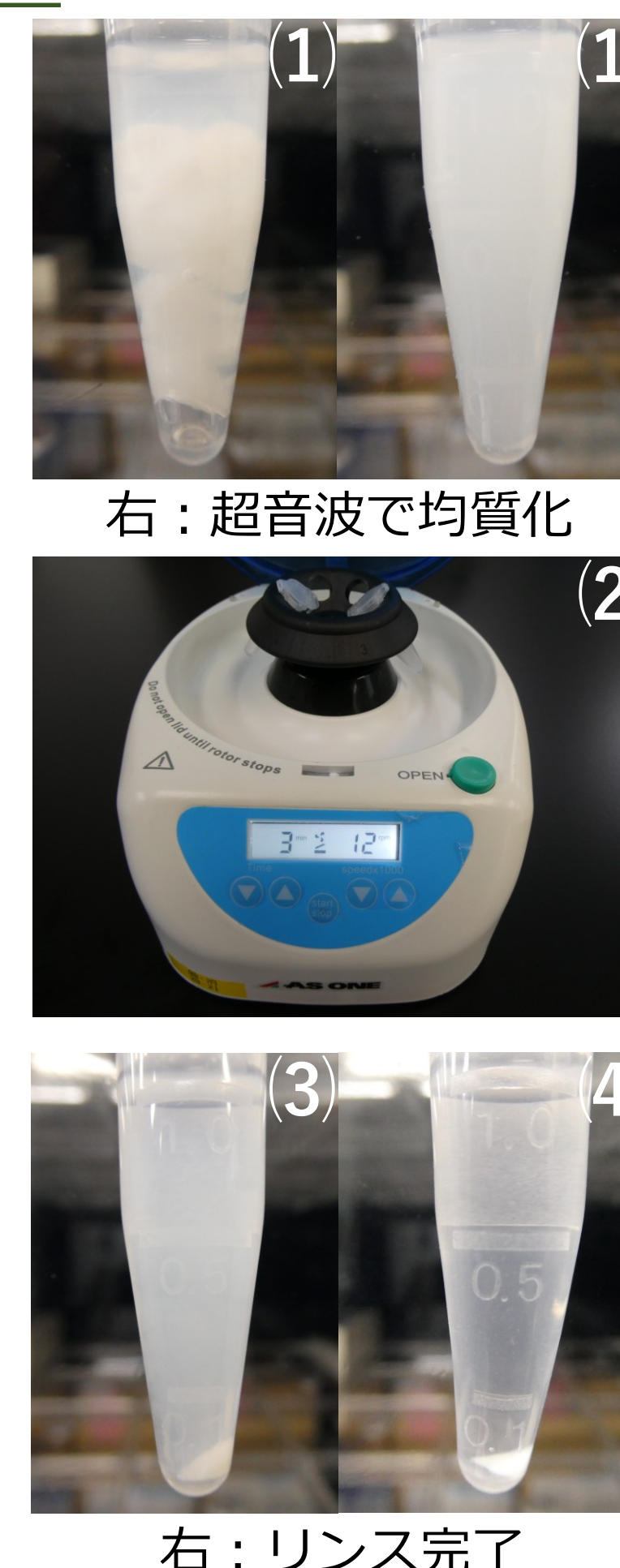
図3 ナノ粒子回収フローとその様子
