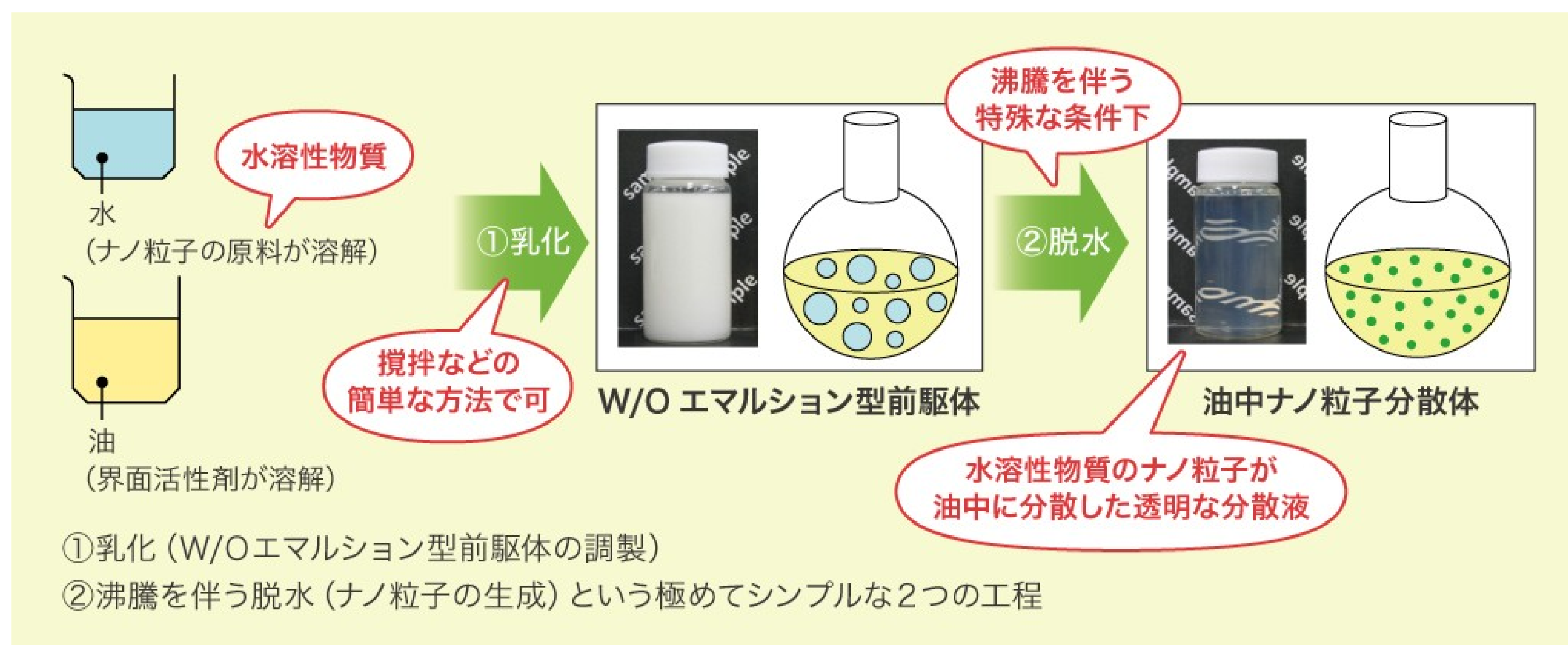
図1 油中ナノ粒子分散体の製造方法
