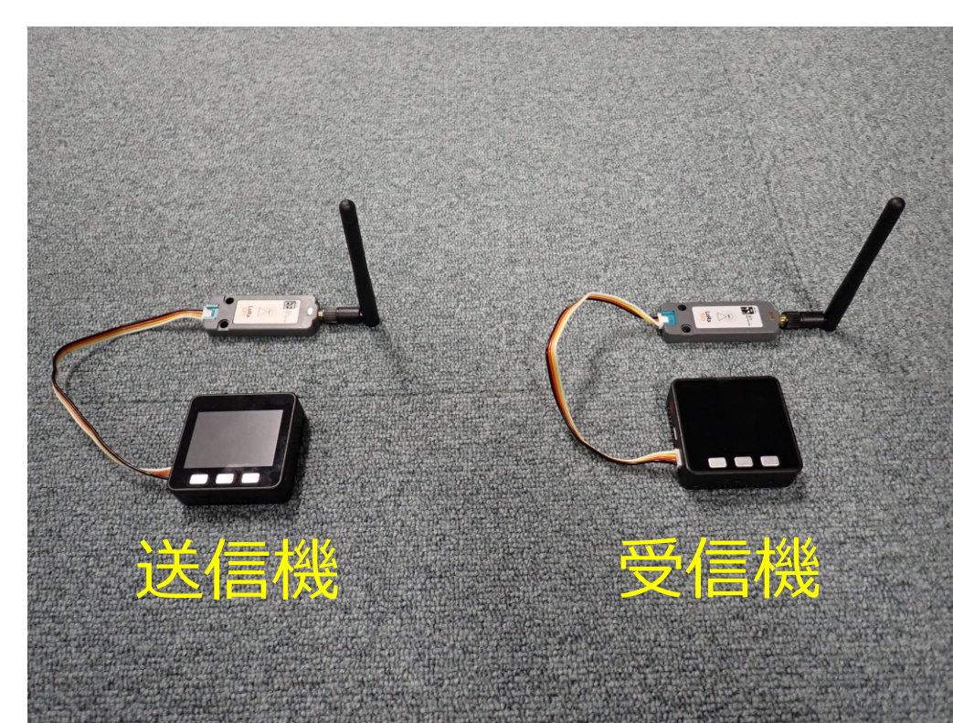
図6 実測に使用した無線機
