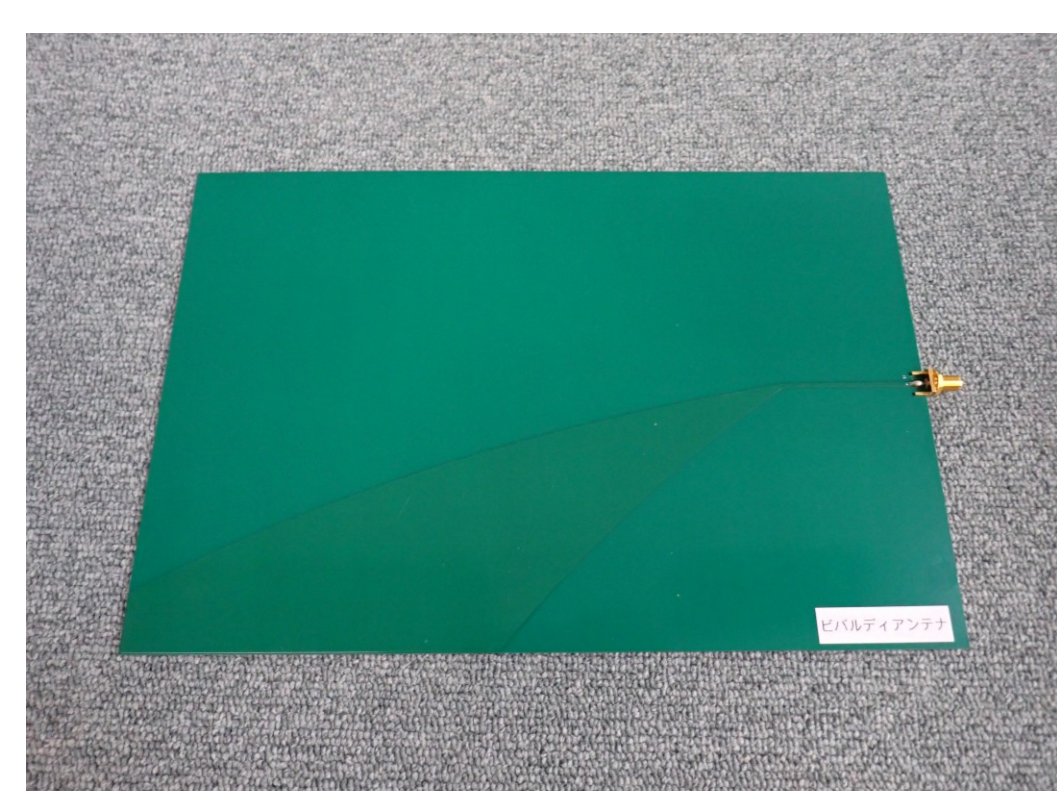
図2 試作したビバルドアンテナ (設計周波数1GHz～6GHz)
