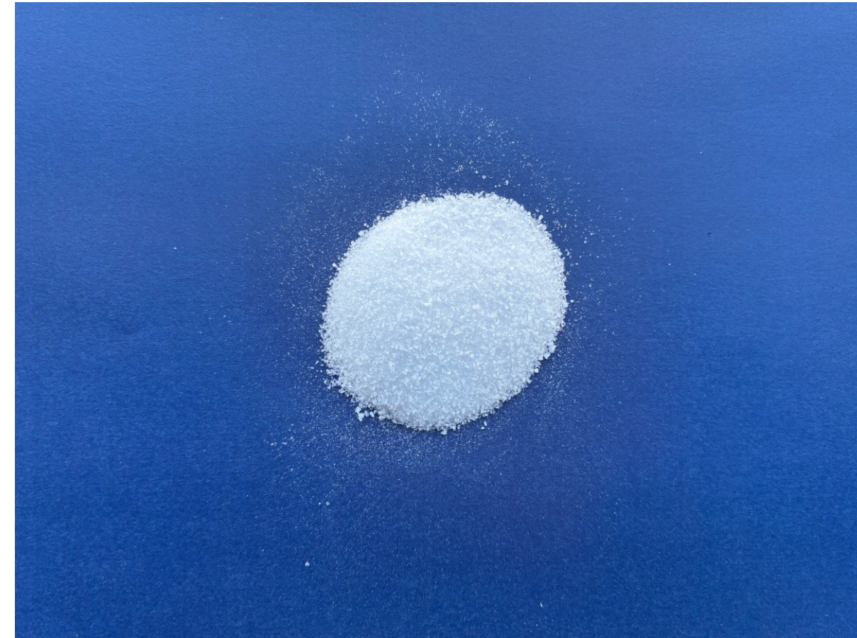
Fig.3 酸処理した基板ガラス（多孔質素材）
