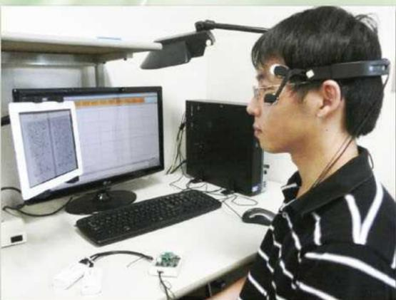
・「噛みしめ」が前進、停止の命令で、「右目瞬き」が右旋回、「左目瞬き」が左旋回の命令となります。電動車椅子をコントロールすることができます。顔の動きと命令の組み合わせを変えることが可能です。
