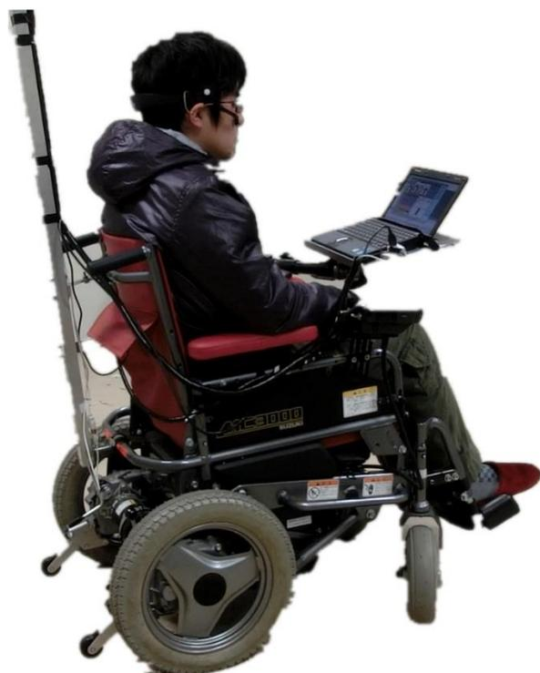
ALS 患者や筋ジストロフィ患者は、病状が進むと筋肉が衰えていき、いろいろな機器が制御できなくなっていく。宮崎大学と宮崎県内企業との共同研究により、比較的病気が進んでも機能が残っている顔の表情筋の変化と視線を同時に計測することが可能な新たな生体信号計測装置ファージ (FARG) を開発しました。ファージは、顔にメガネ感覚で簡単に装着することができる生体信号計測装置です。ファージを用いることで、顔の筋肉を動かすことができる患者は、顔の表情の変化を計測することで電動車椅子をコントロールすることができます。また、電動車椅子に装着しているセンサーを用いて障害物を回避する機能を有しており、走行時の安全性を高める工夫をしています。
