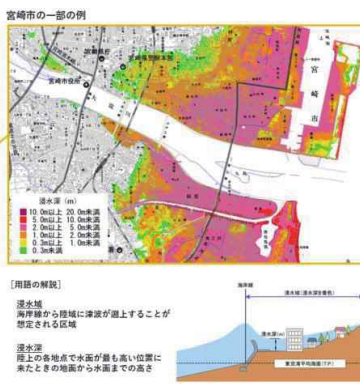
最大クラスの南海トラフ地震で想定される津波による浸水
