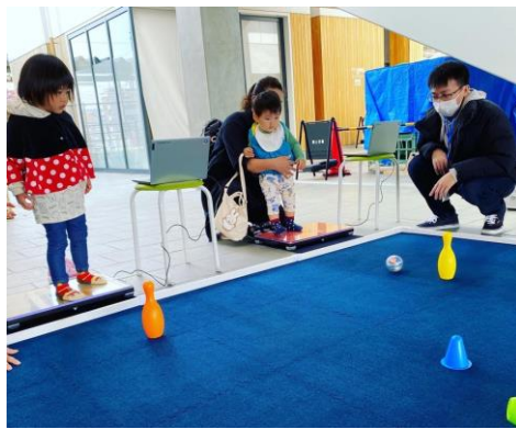
ロボットの構成：ロボット、床反力計、PC。体の重心を前後左右に動かしロボットを操作する。
