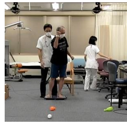
ロボットの構成：ロボット、床反力計、PC。体の重心を前後左右に動かしロボットを操作する。
