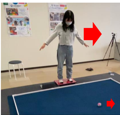
ロボットの構成：ロボット、床反力計、PC。体の重心を前後左右に動かしロボットを操作する。
