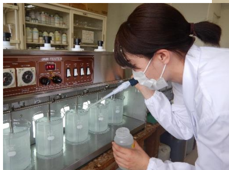
凝集沈殿の実験による 最適な処理条件の設定
