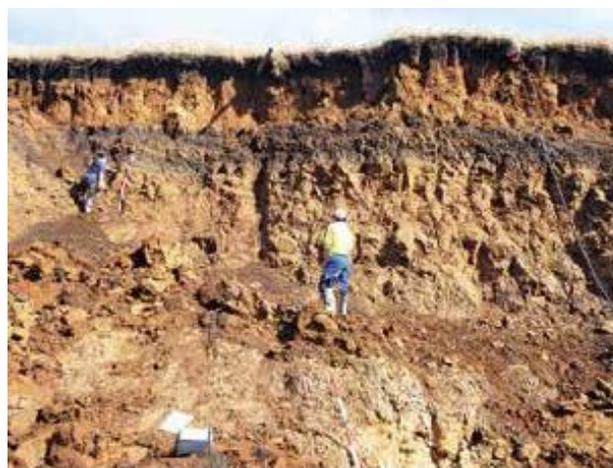
阿蘇カルデラ内の斜面で2016年熊本地震の際に発生した、深さ10mもある大規模な崩壊地を調べています。地盤は全て阿蘇山の降下火山灰層から成っています。
