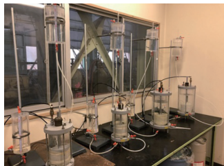
固化処理土の海水浸透・劣化実験
