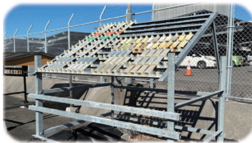
木花キャンパスと延岡フィールドにある 防食技術の腐食性評価のための 暴露試験台
