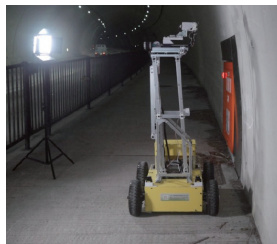
コンクリート構造物の打音ロボット
