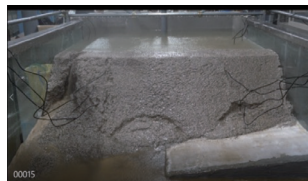
模型実験や数値計算による堤体の崩壊シミュレーション
