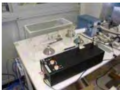
クルックス管および高圧電源
