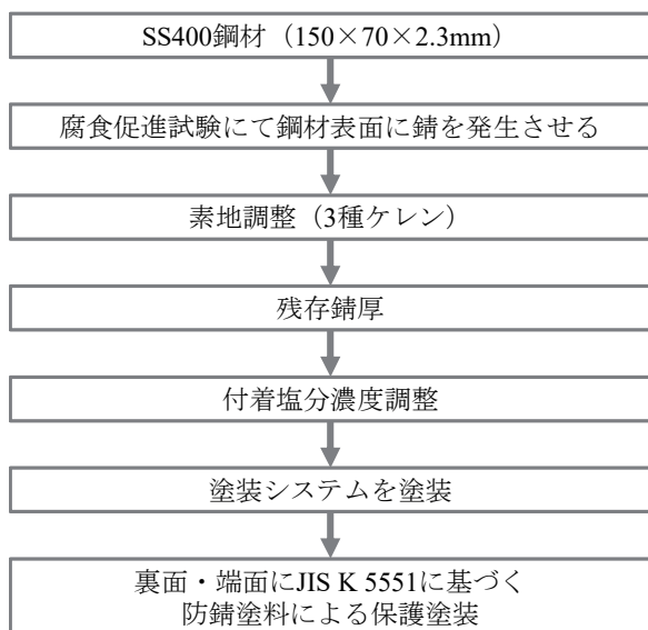
図3. 塗装システムの施工フロー。
