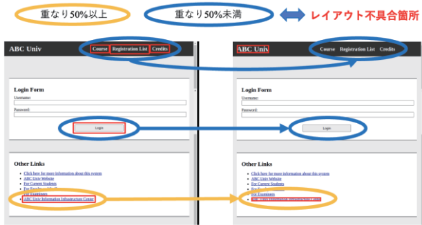
図 10. 赤枠同士の比較によってレイアウト不具合箇所を判定する例（左：差分箇所を強調表示した変更前画像の例、右：変更箇所を強調表示した変更前画像の例）
