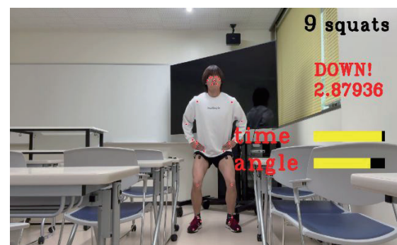
図4:膝の関節角度、経過時間をゲージ表示している様子(上)、ゲージの色が変化している様子(下)
