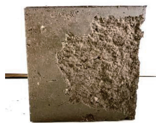
写真 1. 供試体脱型時側面写真 (6cm 立方体供試体 反復回数 2 回目)
