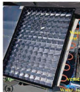
集光型太陽光発電-熱給湯器 複合システムの実証実験
