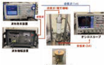
処理土内部を伝わる弾性波の測定
