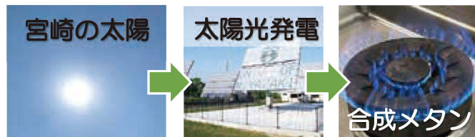
太陽光発電システムの電力をもとにメタン合成。
