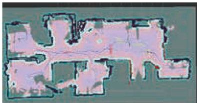
SLAM技術を用いて作成した環境マップとロボットの移動経路
