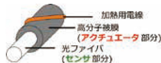
光ファイバセンサを内蔵した人工筋肉
