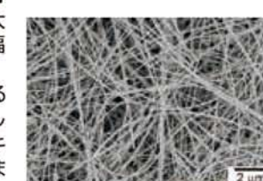
調製したAgナノワイヤの電子顕微鏡像
