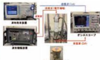
処理土内部を伝わる弾性波の測定
