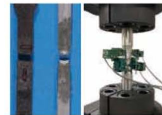
材料の強度実験 鋼自体がどのような強度を持っているのか破壊実験により調査
