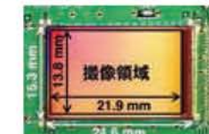
設計・製造したSOI-CMOSイメージセンサのチップ写真
