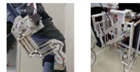
ウェアラブルロボット機構（左：膝関節用、右：股関節用）
