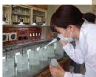
凝集沈殿の実験による最適な処理条件の設定
