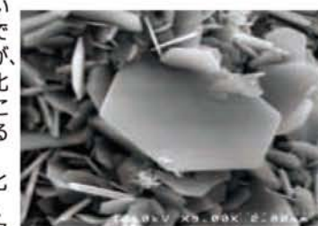
高比表面積水酸化ニッケルから水熱処理で得られたヘキサゴナルプレート
