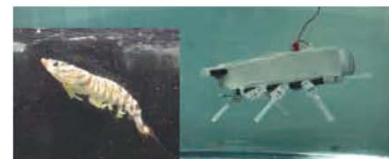
エビの遊泳脚に基づいた水中ロボットの実験様子
