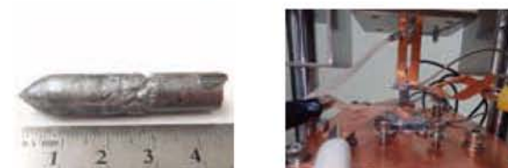
最高性能値を有する熱電材料 熱電変換デバイスの評価実験
