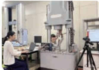
人工関節設置後の大腿骨の強度計測実験
