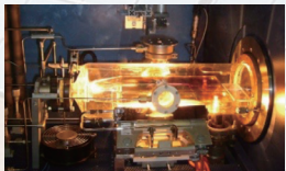
特殊な装置(MOVPE装置)を用いて半導体結晶を成長している様子@東大
