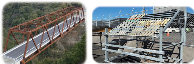
木花キャンパスと延岡フィールドにある 防食技術の腐食性評価のための 暴露試験台
