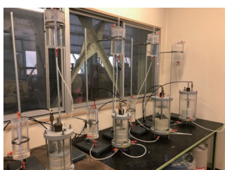
固化処理土の海水浸透・劣化実験
