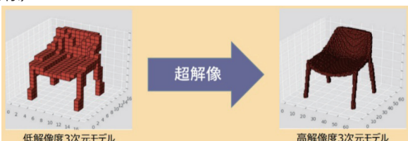
3次元ボクセルモデル超解像
