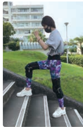
高齢者の歩行と転倒防止、運動機能の補助、 膝患者の機能回復に用いられる膝装具
