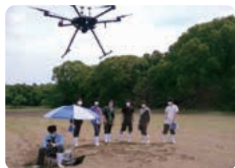
レーザ計測装置をつけたドローンによる農産物の収穫量予測
