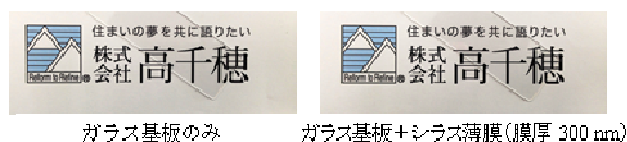
Fig.1 今回開発した高い透明度をもつシラス薄膜
